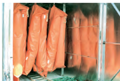
Hengende i takskinner ved hjelp av trinser montert på lensen for hurtig utsetting
