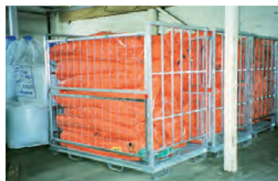
Lagring i pallekasser, 125m, NOFI 250EP klar til utsetting
